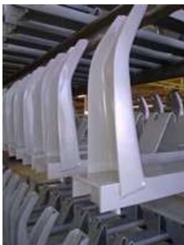
Александровский машзавод первым из производителей ленточных конвейеров освоил для ОАО «Уралкалий» покрытие металлоконструкций эпоксидной грунт-эмалью. На заводе внедрена технология покраски металлоконструкций эпоксидной грунт-эмалью Темабонд. С инициативой освоения новой схемы выступил один из заказчиков – ОАО «Уралкалий».
